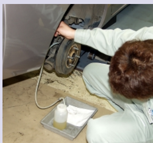
リヤはIGスイッチをONにしてから、ブリーダプラグを解放するだけ。
