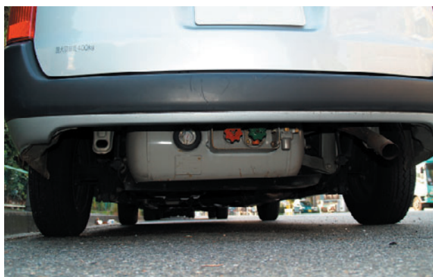
フロア下部に取り付けられたLPGボンベ。デュアル燃料方式なので、既存のガソリンタンクも装着されています。
