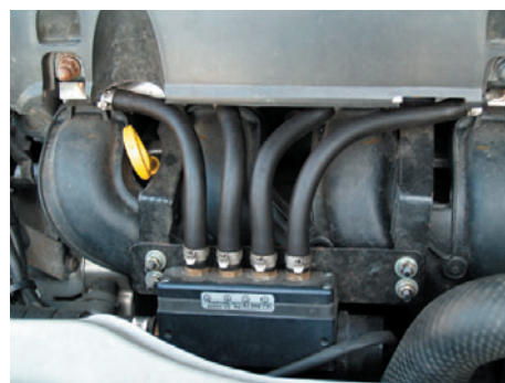
LPG噴射装置をはじめ、それぞれのキットはエンジンルームの空きスペースに装着されるため、車両ごとにステーやブラケットを手作りします。
