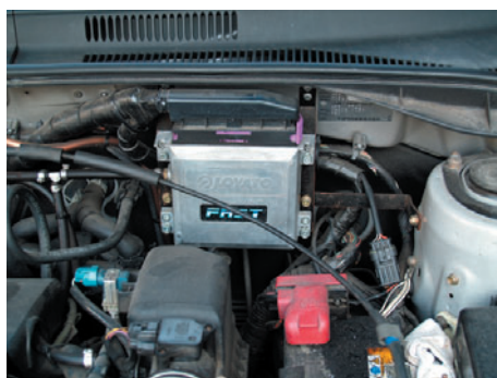
エンジン・コントロール・ユニットと連動するLPGコントロール・ユニット。
