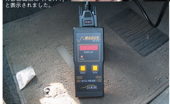
下の写真では判別しにくいですが、チェッカーの診断結果は「P0171」と表示されました。
