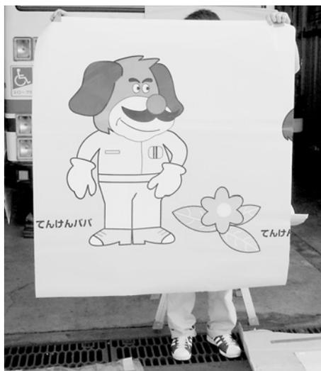
▲ラッピングステッカーのサイズは大きいもので140cm×120cm位。貼る箇所によってサイズは違います。専用の厚いフィルムで、貼り直しもできるものだそうです。バス1台ラッピングするのに、このステッカーを25～6枚使います。
