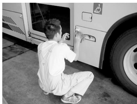
▲まずは下準備から。きっちり洗車をして、ラッピングステッカーがはがれないように油膜や汚れを落とします。
