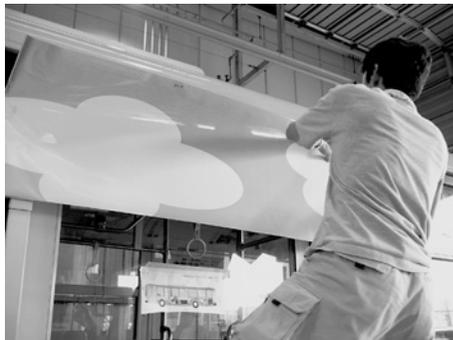
◀縁を控え、屋根の窓枠を貼ります。(大きなステッカーから貼るので、割と小さな窓枠ステッカーは後から貼るようになります)
