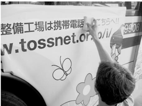
◀凹凸や、ナンバープレート、灯火類の箇所はこの段階では関係なく貼ります。また、バスの形に合うようにカッターで大雑把に形を整えます。(タイヤ部分など)
