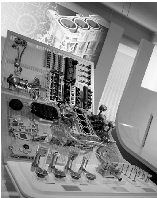
エンジンの仕組みを理解するための分解標本
