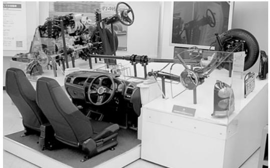
アルトワクス(suzuki)の駆動制御モデル。実際に運転席に座りながら自動車の仕組みを勉強できる。ABSやペーパーロック現象を体感できる貴重な展示品だ
