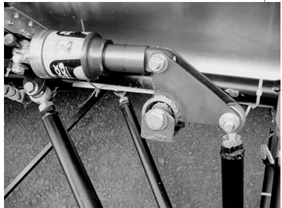
競技用自転車からの流用品であるショックアブソーバ。軽量化を考慮してのアイデアだ。
