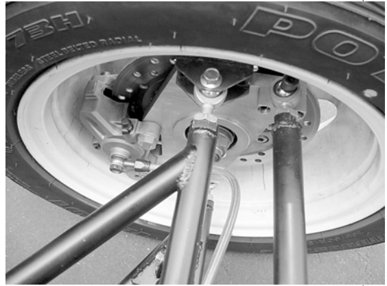
ブレーキキャリアがホイールと接触しないよう、加工するのに苦労したという。
