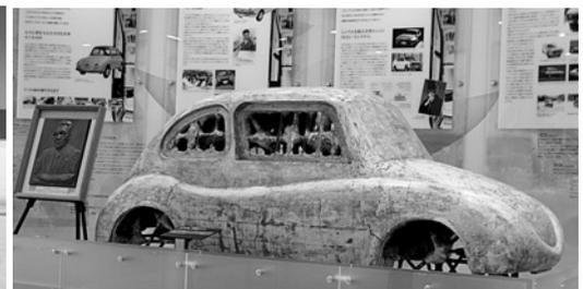
スバル 360（通称：てんとう虫）の石膏モデル。スバル 360 は線図から模型をつくるのではなく、石膏モデルから線図を起こすという一般とは逆の工程で製作進行された。通常は破棄される石膏モデルがこのようなに残されるのはまれ。
