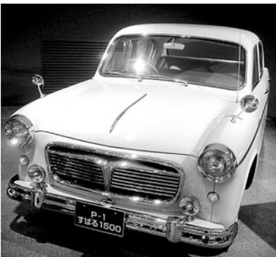
幻の車「P-1」。富士自動車工業(現在の富士重工業の前身)が昭和29年に試作1号車を完成させ、翌年には生産車が誕生。1500cc、6人乗り4ドアセダンで、「モノコックボディ」「独立懸架方式」など当時としては革新的な技術を採用していたが、諸般の事情により発売されなかった。もちろんこの車両も自走できる状態で保存してあ
