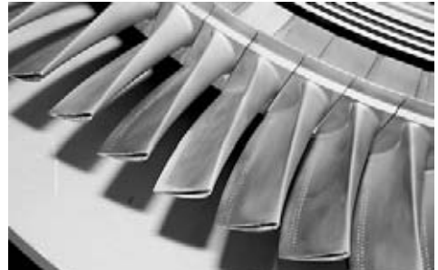
エンジンの“タービンブレード”。一枚の値段が約90万円というから驚き。1台のジェットエンジンでこの羽が約80枚使われているという。
