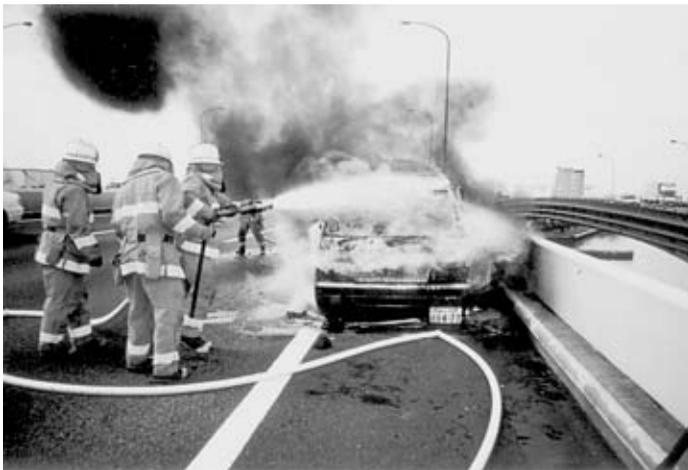
ワンボックスタイプの車両のように、原動機部分が床下に隠れている車両は直接消火活動を行いにくいいため、全焼火災になりやすい。
