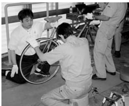
は大きく分けて4つ。「目視検査」「締付検査」「加重検査」「測定検査」という内容になっており、合わせて47箇所を確認します。この全てをクリアできない自転車は競技に参加することができません。検査で不合格になった場合は、自転車の該当部位を補修または交換した後に再度検査を受け、合格する必要があります。さらに走行後にも検査を必ず行いますが、これは「自転車の検査業務」後に改造したり、申請と違う自転車で競技に参加していないか確認するためのものです。
