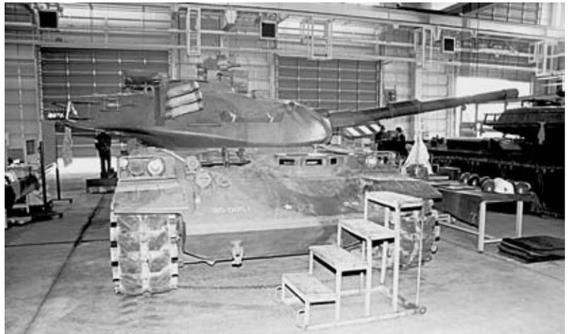
写真の74式戦車は、戦後初の国産戦車である61式戦車の後継車両として開発された、陸上自衛隊の第2世代主力戦車である。三菱重工業製ZF系列の空冷ディーゼル・エンジンが搭載されており、2ストローク・エンジンながらターボ過給を行っている。エンジンと変速・操向装置を一体化したパワーバック方式(エンジンやミッション等がカートリッジのように容易に取り外しできる機構)を採用し、整備性が高い。他にも数々の特徴を持ち、日本の地形に合わせた、独自の技術を採用した戦車に仕上がっている。なお、乗員は、車長、砲手、装填手、操縦手の4名。
