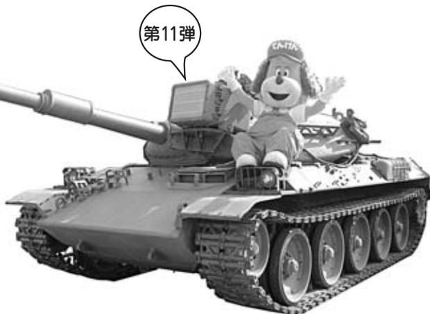
重さ38トン、最高時速53キロ。720馬力の心臓をもち、105mm砲をはじめ、重機関銃などを装備する鋼鉄の獅子、74式戦車。
