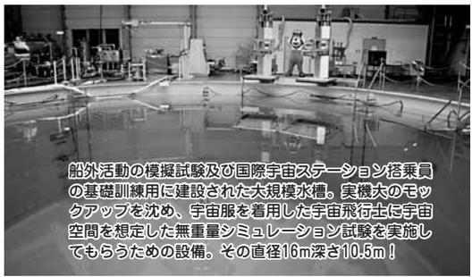
船外活動の模擬試験及び国際宇宙ステーション搭乗員の基礎訓練用に建設された大規模水槽。実機大のモックアップを沈め、宇宙服を着用した宇宙飛行士は宇宙空間を想定した無重量シミュレーション試験を実施してもらうための設備。その直径16m深さ10.3m!
