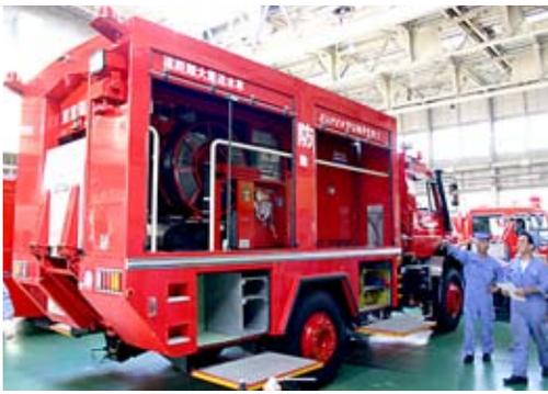
水源から遠く離れた火災に対応するための特殊車両「遠距離大量送水車「SUPER PUMPER」。
