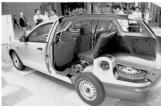
車両をカットし、天然ガス自動車の構造を展示
