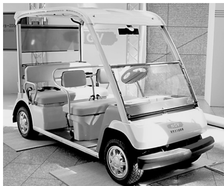
ゴルフカートを改造し天然ガス自動車の試乗車を製作
