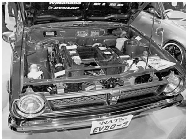
専門学校からは、原動機を電気モーターに変えた旧車カローラを出展、ブレーキにはバキュームポンプとタンクを使っていた。
