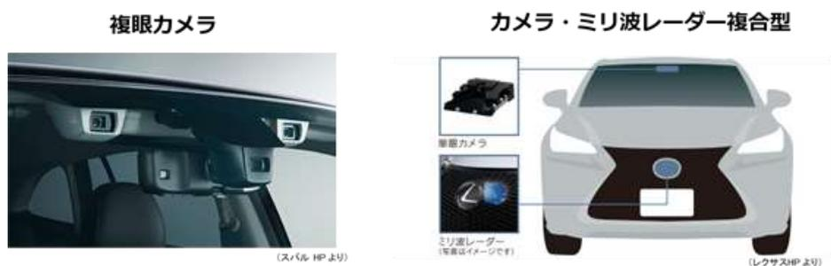
22 図：市販車に搭載されている、前方をセンシングするためのデバイス例
