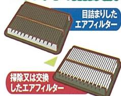
フィルターの目詰まりを解消してスムーズに空気が送られ、エンジン性能が回復します。
