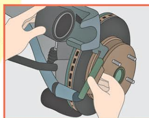
5 制動装置 (ブレーキパッド等、ブレーキ部品の交換)
