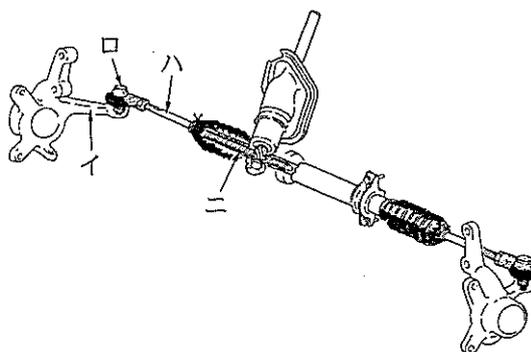
〔No. 10〕 インテグラル型油圧式パワー・ステアリングにおいて、ステアリング・ギヤ・ボックスの内部に収められている構成部品の一つとして、適切なものは次のうちどれか。
