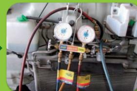
環境に影響を与えないように回収したフロン類(エアコンガス)は破壊処理を施します。
