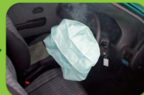
エアバッグなどは、未展開のものがあれば、強制的に電気信号で展開、作動させて安全な状態にし、作動後は有用資源(アルミなど)としてリサイクルされます。
