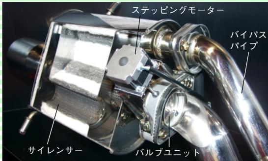
出力特性と排気音量を自在にコントロールできる最新スポーツマフラー。室内に設けたコントローラーで好みのモードを設定すると、サイレンサー前部に取付けられた「ステッピングモーター」とバルブユニットが排気の流れをリアルタイム制御する。
