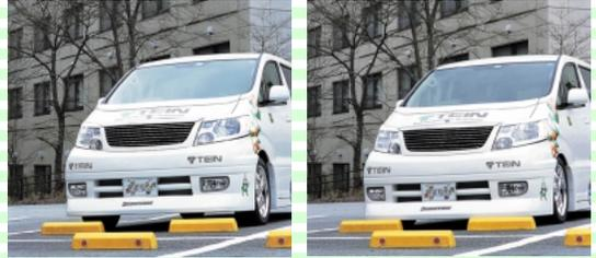
室内に装備したコントローラーからボタンひとつで好みの車高に調整できる。緩衝装置と油圧車高調整機構は独立しており、最低地上高90mmから140mmまでの調整を約10秒で行える。万が一、油圧機構が故障しても最低地上高を確保するように設計されている。
