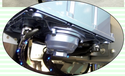
「尿素水圧送装置」の底部にフィルタが設けられているので、10万kmまたは1年ごとに点検・交換する（メーカー推奨）。
