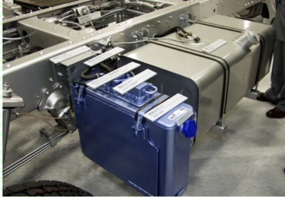
尿素水タンクには水位を測定するセンサのほか、寒冷地での凍結を防ぐ「解凍&保温システム」などが装備されている。
