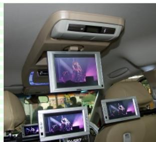
これに伴って車載用モニターがボルトオンで手軽に装着できる「ルーフマウントTV基台」の注目度が高まっているという。これは、モニターを天井に固定するマウントキットと化粧カバーを車種ごとに専用設計し、室内の景観や質感を損ねずに後付けできるのを特徴とし、ヒンジ付のタイプはモニターの角度調整が容易にできるうえ、未使用時に天井部へ折りたたんで収納することもできる（写真参照）。
