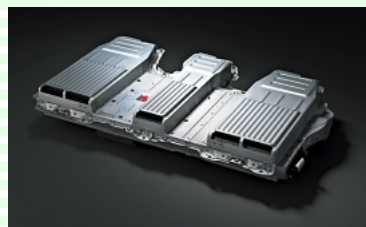
HVバッテリーは「密閉式角型ニッケル水素バッテリー」を後部座席の下へ3分割して搭載した。
