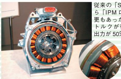
従来の「SPMロータ」から「IPMロータ」への変更もあったモーター部は、トルクが従来比14%増、出力が50%増を実現した。
