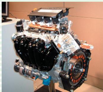
◀減速時にエンジンが気筒休止した際、4気筒すべての燃焼を休止させシリンダ内を密閉に保ち、吸・排気に伴うポンピングロスを低減することで、減速エネルギー回生量を従来に比べ約10%向上させた。システム出力は115PS (85kw) と、従来の約20%増を実現。
