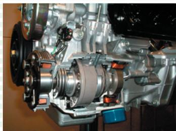
◀エンジンとモーターどちらでも駆動する「ハイブリッドコンプレッサー」が初めて搭載された。アイドルストップ時および温度安定時にはモーター駆動し、急速冷房時はエンジン+モーター駆動する。
