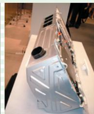
バッテリーとインバータ、DC-DCコンバータ、エアコン制御ユニットが一体化した新IPU (Intelligent Power Unit) は、各部品の小型化により容積を従来比13%減、重量を同等に抑えた。
