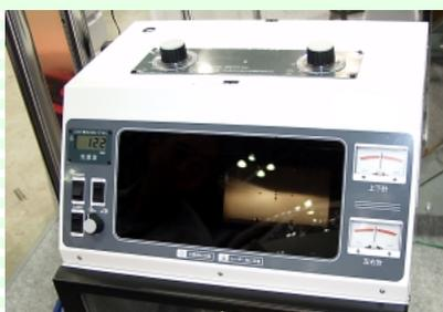
◀ テスタ上部のダイヤルとスクリーンが機械的に連動している。調整時はダイヤルを回して先にスクリーンを合格位置にセットし、カットオフがスクリーンの中心に合うまでライト側を調整する。
