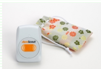
ICタグとお守り袋。タグの中心に「通報ボタン」が組込まれている。
