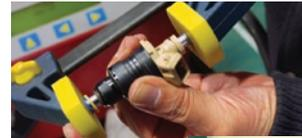
フィルタやOリング、キャップなど汎用の補修パーツが用意され、インジェクタの再利用が可能。
