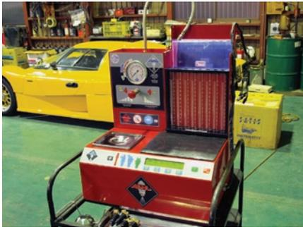
インジェクタのスプレーパターンや噴射量、リークなどが個別に観測できる。また特殊な洗浄剤を使った超音波(ウルトラソニック)洗浄も可能だ。
