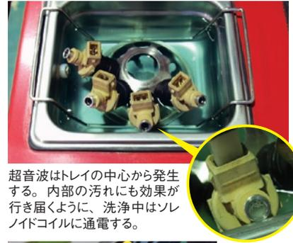
超音波はトレイの中心から発生する。内部の汚れにも効果が行き届くように、洗浄中はソレノイドコイルに通電する。
