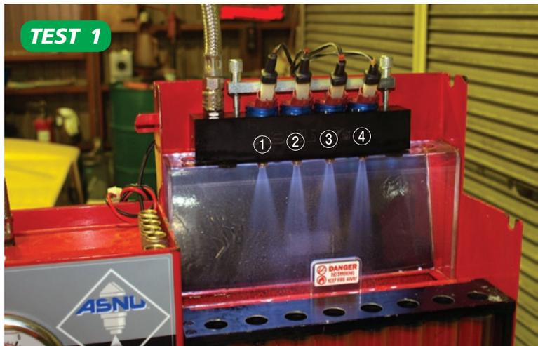
本来、すべてのスプレーパターンと噴射量が同じでなければならないが、①のインジェクタだけは他に比べてスプレーパターンが広く見える。この場合、吸気ポートの壁面に当たり液状となった燃料が燃焼室に流れ込む「壁流」(へきりゅう)の発生が心配される。
