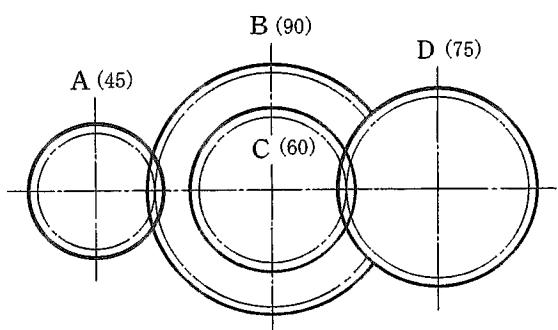
[No. 27] トルク・レンチに図のようなアダプタを取り付けて締め付けたとき、トルク・レンチの読みが  $100 \text{ N}\cdot\text{m}$  だった。このときのナットの締め付けトルクとして、適切なものは次のうちどれか。
