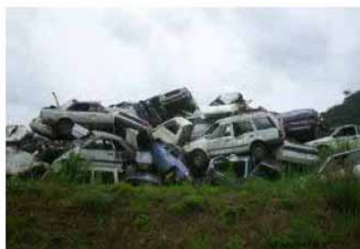
〔乱雑で不適正な積み方の例〕
