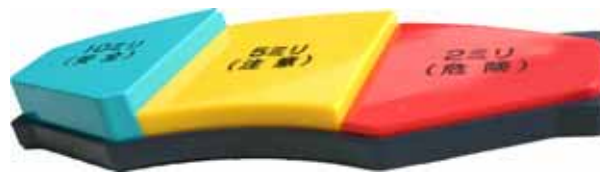
ブレーキの摩擦材の残量で危険度を測定する模型
