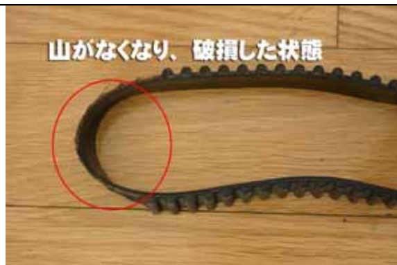
破損したタイミングベルト
