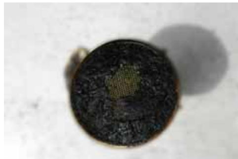
スラッジにより目詰まりしたオイルストレーナ
