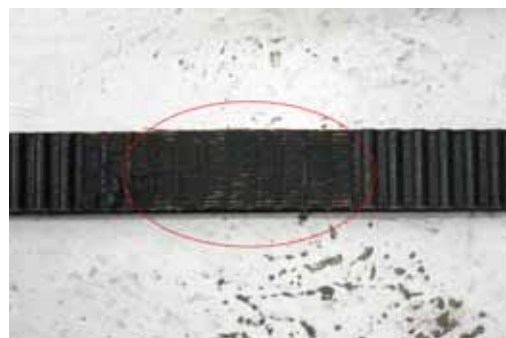
経年劣化によりコマが飛んだタイミングベルト
