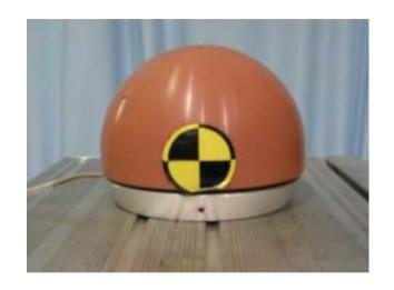
頭部インパクタ 大人用(直径165mm、質量4.5kg) 子供用(直径165mm、質量3.5kg)
