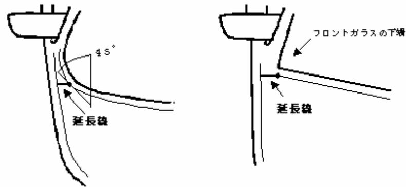
図 4 ボンネット後部基準線の延長方法
