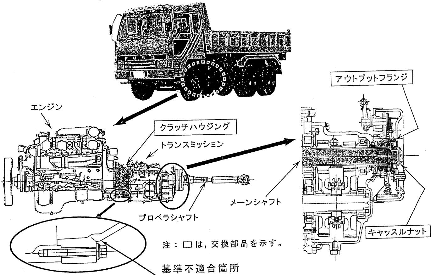
エンジンと変速機(トランスミッション)の結合部(クラッチハウジング)の剛性が不足しているものがあり、また、トランスミッション・メインシャフト後部のスプライン部と継ぎ手(アウトプット法兰ジ)の噛み合い部分の隙間が不適切なため、当該隙間が経年変化などで増大すると、高速走行時の駆動系振動が大きくなり、クラッチハウジングに亀裂が生じるものがある。また、クラッチハウジングに鋸造時の傷などがある場合、この亀裂の発生が早まる可能性がある。このため、そのままの状態で使用を続けると亀裂が進行し、最悪の場合、クラッチハウジングが破断してトランスミッション又はプロペラシャフトが脱落、又は周辺部品を破損させ二次的不具合を生じるおそれがある。
