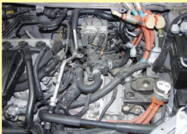
初代プリウスは、エンジンやヒーターコアのウォーターホースを交換するとき「インバータ」を取り外さなければなりません。ご存じでしたか？
