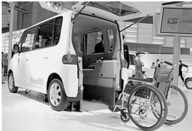
●ダイハツ工業㈱「タントフロアリフト」 フロア部分の電動昇降機能により車椅子に座ったままで 楽に乗降可能
