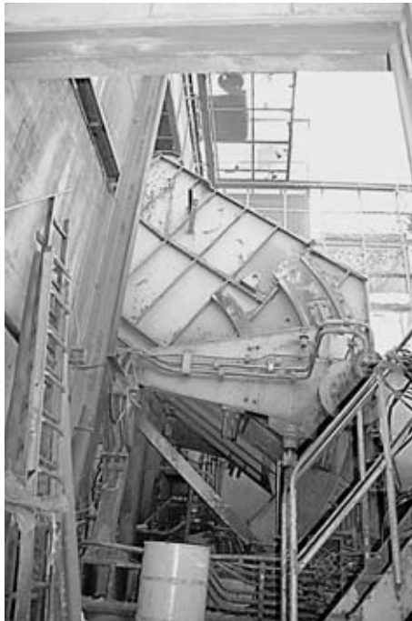
シュレッダーマシンの破碎機構。回転する支柱(左下)の中でハンマー状の歯(左上)が遠心力により激しく動き、自動車を破碎する。写真右は普段立ち入ることのできない破碎装置内部。
