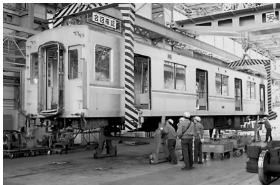
台車が取り外された車体は、専用の台の上で点検整備!!
