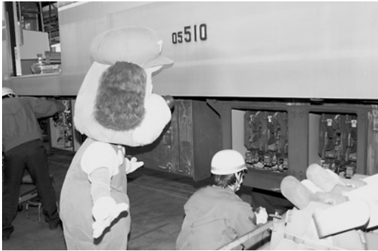
「床下機器の取外し」:各種機器を収納箱ごと取外し、分解。定期交換部品の取替え、不具合箇所をメンテナンスし機能回復!!
