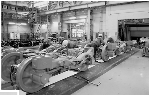
「台車の分解」:台車から主電動機(モータ)を取外し、台車を台車洗浄装置で洗い、さらに車輪と台車枠とに分解し、各部分を検査!!
