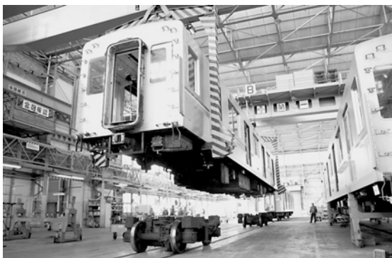
「台車抜き」：無線操作による大型クレーン2台で車体を持ち上げて、車体と台車を分離します。
