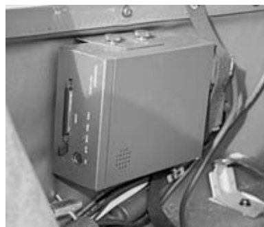
「タコビット」。スピード、急発進・停止、急カーブを音声で警告してくれる。さらに、ドライブレコーダーの機能も持っているスーパー教官だ。
