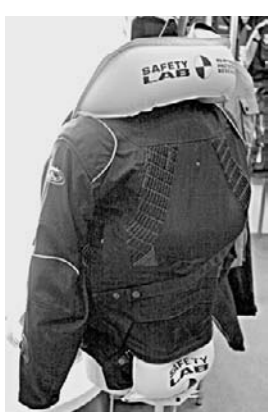
「ヒットエア付ジャケット」 作動時には、えり部分から コアが飛び出し首を守る
