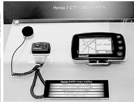
防水防塵構造の二輪車用ナビ Honda Access「Gathers M」
