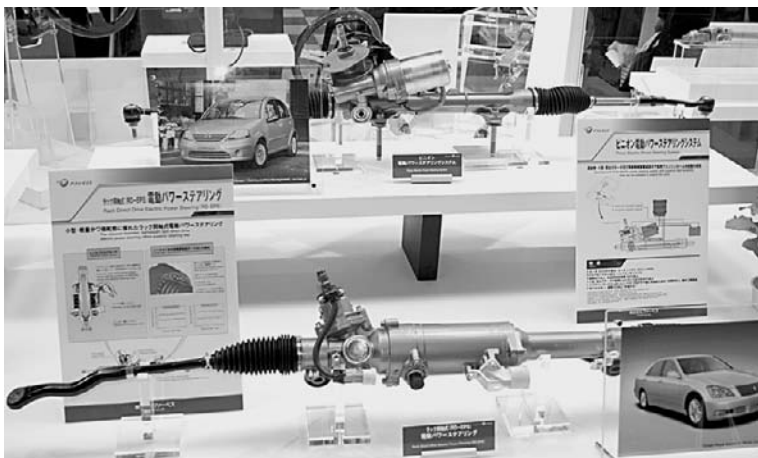
③光洋精工「電装パワーステアリング」モータ位置により多種の展示がされていた
