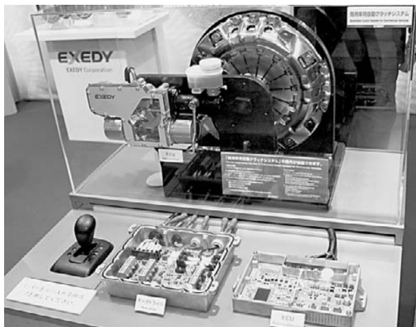
◎エクセディ「商用車用自動クラッチシステム」既存ミッションに追加するだけで自動クラッチシステムが簡単に構築
