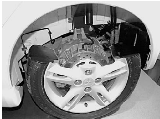
①コルトEV ホイール部にモータを内蔵した「インホイールモータ」
