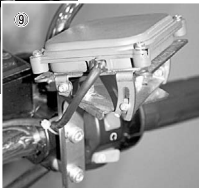
⑦、⑧、⑨ 「インジケータ」「アンテナ」はハンドルやブレーキの止めボルトを使って取り付けている
