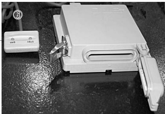
耐熱、耐振動、耐水性能を上げるため、ETCカードはケースの蓋を開けて挿入する。
