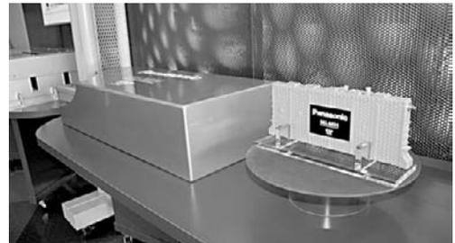
日産の最新燃料電池車に補助動力用として搭載されている薄型ラミネート型セルを採用した「コンバクトリチウムイオンバッテリー」。従来の円筒形リチウムイオン電池に比べ重量・体積がそれぞれ約半分、パワーは1.5倍という高性能を誇るという。燃料電池車走行時に車輪回転から回収できるエネルギーを電気として蓄電する。
