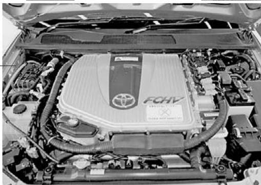
トヨタが開発した一世代前の燃料電池車FCHV-4。銀色のボックスは電気系統のコントロールラダーで、その下に搭載されている燃料電池(スタック)で発生した電気を直交変換したり電圧変換を行う。エンジンルーム右上には普通のバッテリーが見える。このバッテリーは、後部座席裏側に搭載されている補助動力用二次電池とは別で、前照灯やオーディオ類などのアクセサリ電源として使われる。
