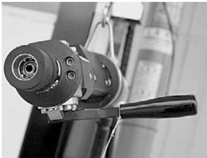
燃料電池車へ水素を注入するためのノズル。水素が漏洩しないよう、多くの工夫が施されている。空気中における水素の燃焼範囲(大気中で爆発する濃度)は4~75%と広く(ガソリンの燃焼範囲は1.4%~7.6%)、静電気でも着火してしまうため、取り扱いには注意が必要だ。なお、一般燃料と比較し水素が燃焼しても可視光線が少なく炎は目視し難い。
