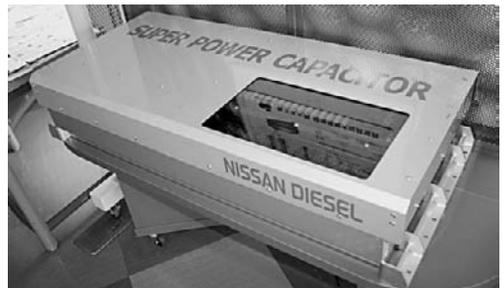
「キャパシター」と呼ばれる補助動力装置。燃料電池車走行時に回収できるエネルギーを電気として蓄電し、短時間に放出することでモーターの出力を高めるのに用いられる。一種のコンデンサーである。
