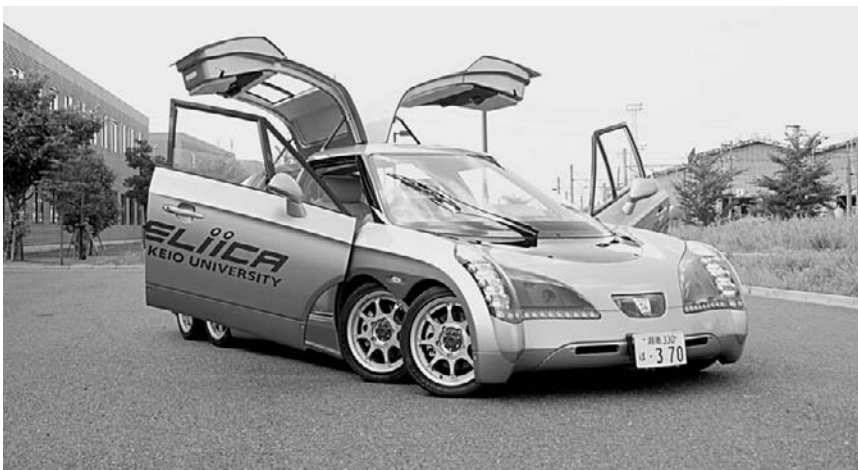
Eliicaは全長5.1メートル、全幅1.9メートル、全高1.3メートル超と大サイズだ。
