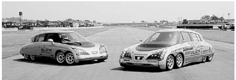
Eliicaはその研究目的から2タイプが試作された。右側が高速仕様(最高時速370km)、左側が高加速仕様(加速度0.68G)だ。
