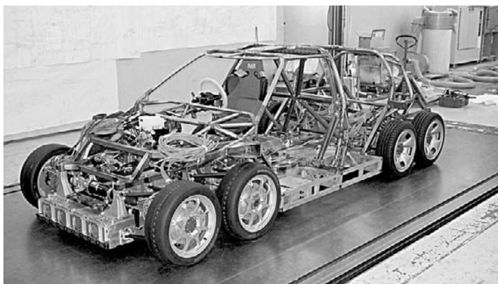
Eliicaのフレーム。写真からでも高い剛性と安全性が予測できる。
