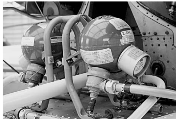
ジェットエンジンの付け根に備え付けられている消化器。
