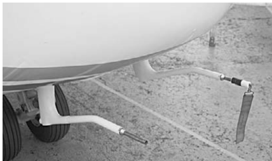
ヘリコプターの前面に設置されている「速度計」。先端から入る空気の圧で速度を測る。
