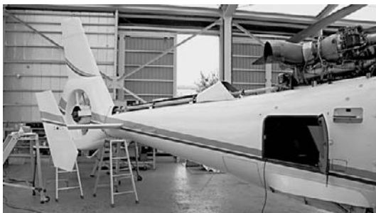
点検作業中のテールローターを接写!
