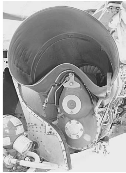
ジェットエンジンを後ろから撮影！爆発エネルギーを回転エネルギーへと変換する第一タービンが奥に見える。
