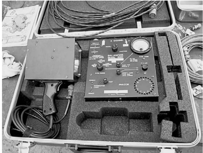
② 各ローターのバランスを取る機械。こういったテスター類の校正は欠かせない。
