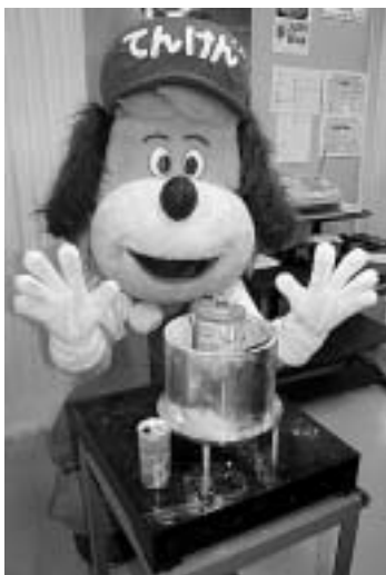
MAGICエンジンの実物に感動！手前のコーヒー缶と比べるとその小ささがわかる！このサイズで100kWの熱量が出せる。
