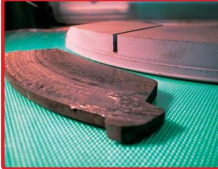
ブレーキパッドは自動車を減速、停止させるための部品。写真奥が新品です。手前のパッドは摩耗が激しく、ディスクローターにも傷を与えてしまいました。早めに交換しておけば、修理費用の負担も軽減できました。
