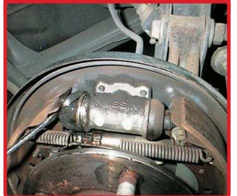
ブレーキホイールシリンダはブレーキシューをドラム部分へ押し付ける部品。中のゴムが劣化すると、オイルが漏れてしまいます。また、ブレーキ内にオイルが回り、ブレーキが利かなくなることも。ブレーキが利かなくなった場合を想像しただけでもゾッとします。
