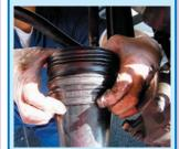
アウタージョイントにかぶせてブーツをずらし、専用工具から取外す。
