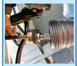
ドライブシャフトのアウタージョイントは分解せずに専用工具を挿入する。
