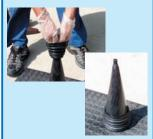
①ブーツの小径側から挿入する。 ②体重をかけて一気に下まで押 し下げる。
